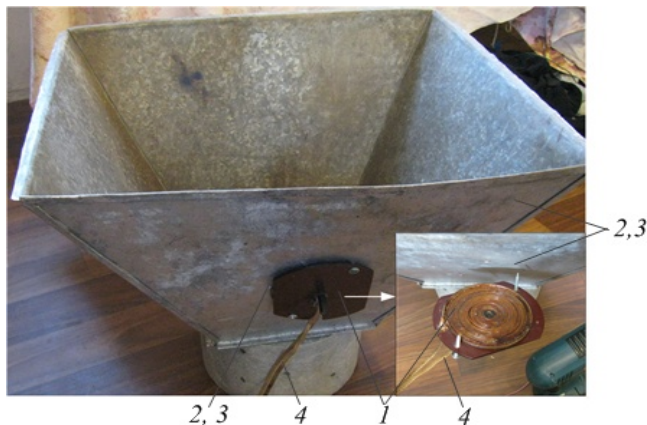
Рис. 10 – Экспериментальный макет бункера с устройством ударно-механической очистки
