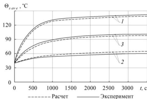
Рис. 5 – Расчетные данные и экспериментальные по нагреву обмотки статора ДКР ВР-250/2:
