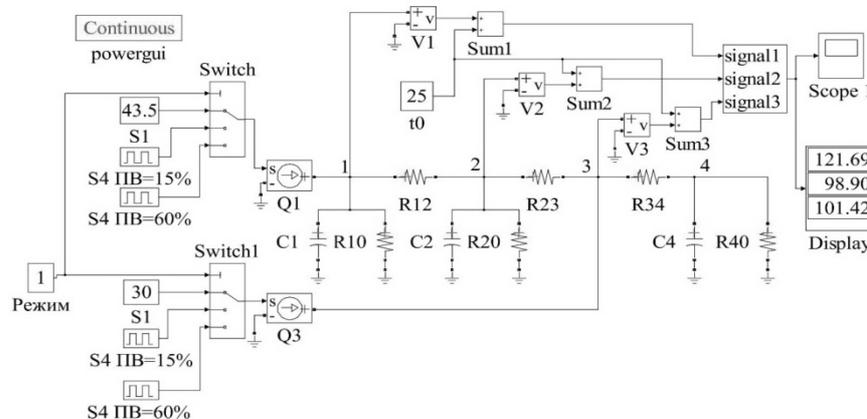
Рис 4 – Структурная схема ДКР открытого исполнения для определения температуры его активных частей
