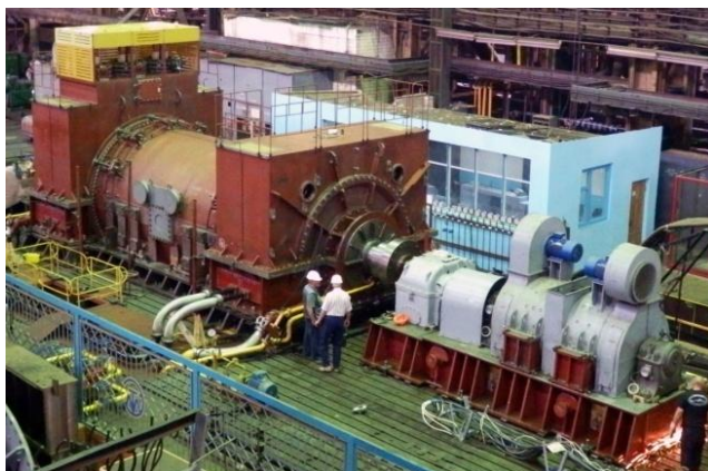
Рис. 4 – Випробувальний стенд турбогенератора на стенді заводу ДП «ЗАВОД «ЕЛЕКТРОВАЖМАШ»
